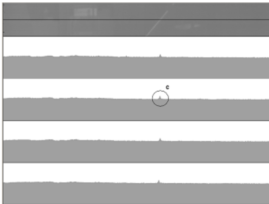
Рис. 6 Диаграммы яркостей 4 строк выбранного фрагмента изображения после фильтрации аппаратных помех. с — яркостной контраст, принадлежащий объекту.
