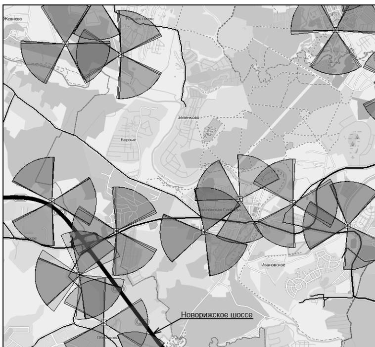
**Рис. 3.** Фрагмент расположения базовых станций оператора сотовой связи для участка дорог Подмосковья. Секторы станций соответствуют диаграммам направленности излучения антенн.
