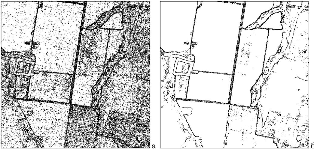
Рис. 4. Обнаружение контуров: а) по исходному изображению (Рис. 3,а); б) по сглаженной компоненте  $S_{mn}$ .
