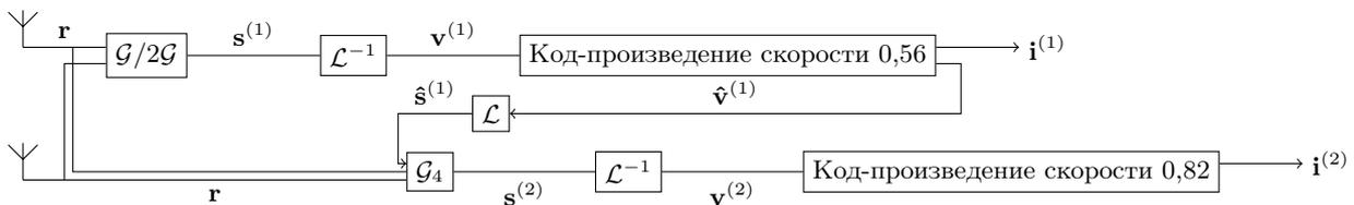
Рис. 1. Блок-схема декодера обобщённого каскадного кода.
