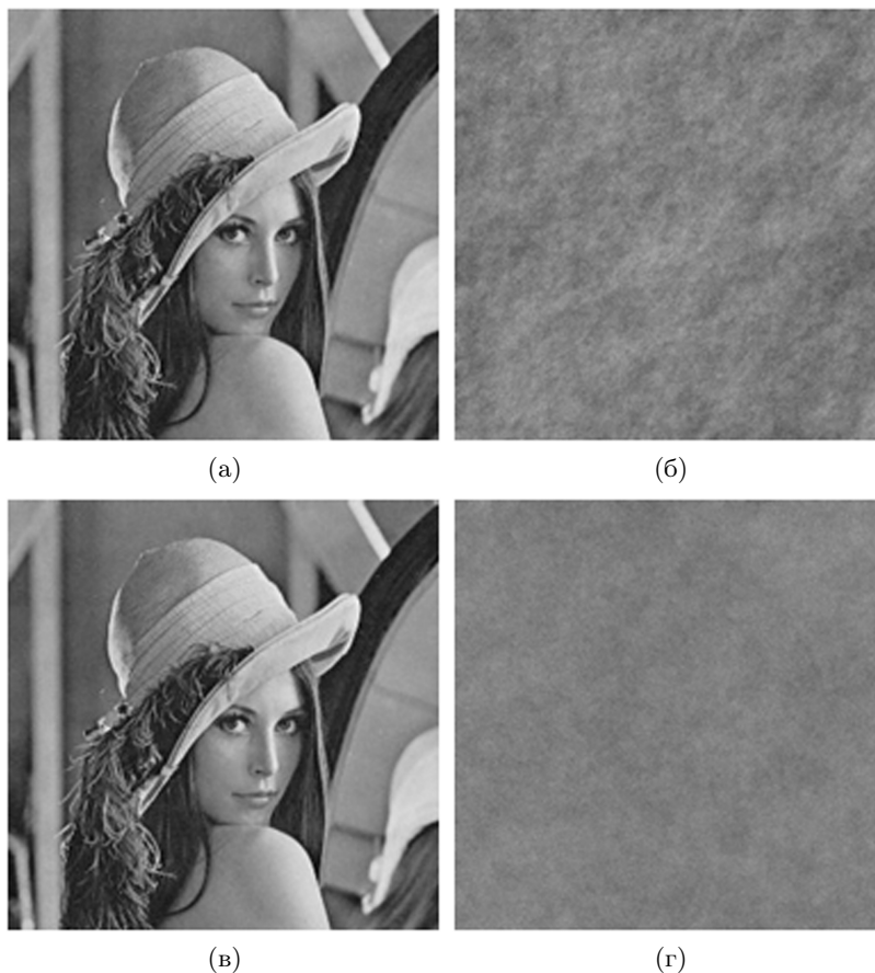
Рис. 5. Результаты восстановления с помощью предложенного метода для аддитивной помехи: (а) восстановленное изображений с использованием трех изображений, (б) усиленная разница между исходным и восстановленным изображениями с использованием трех изображений, (в) восстановленное изображение при использовании пяти изображений, (г) усиленная разница между исходным и восстановленным изображениями с использованием пяти изображений.
