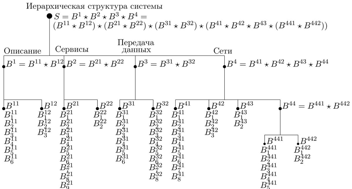
Рис. 5. Иерархическая модель беспроводной мобильной системы
