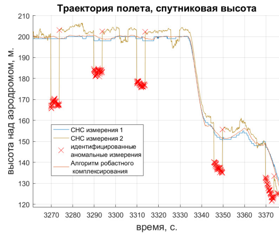
Рис. 8. Измерения спутниковой высоты и ее оценка, полученные в ходе испытательного полета. Красными символами "x" помечены обнаруженные аномальные измерения
