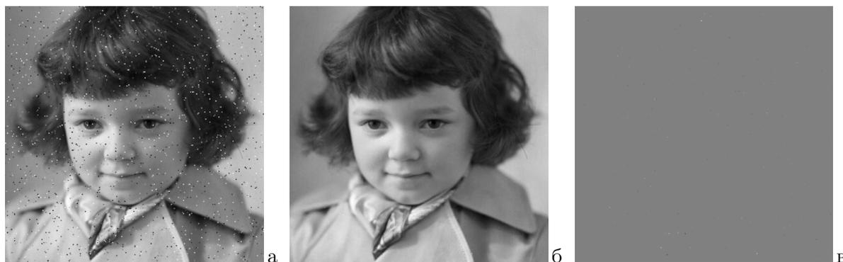
Рис. 1. Обнаружение импульсных помех: а) зашумленное изображение (шум 3%); б) значения восстановлены в точках обнаруженных помех; в) разность (б) и неискаженного изображения.
