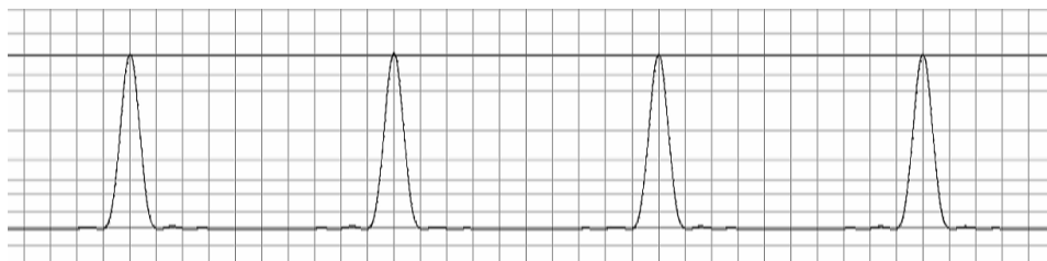
Рис. 15a. Общий вид частотной характеристики фрагмента трехэлементного компенсационного фильтра с 8, 7 и 6 элементами задержки.
