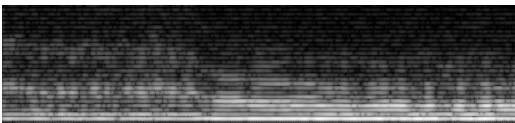
Рис. 9j. Результат выделения голоса певицы в конвейере резинового времени фильтрацией гребенчатым селектором с основной частотой 50 Гц.
