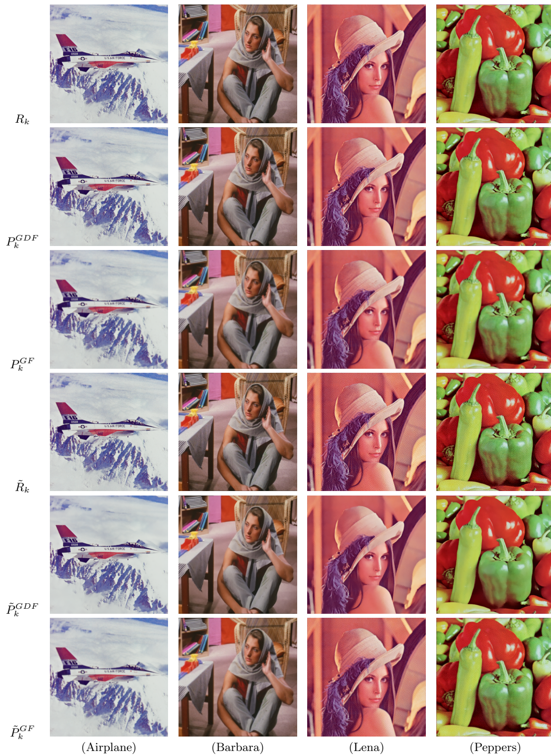
Рис. 2. Результат подавления артефактов для визуального сравнения. В этом случае мы сравниваем предложенный алгоритм со стандартной постобработкой P_k^{GF} . Значение параметра дефокусировки для изображения Airplane \sigma_B = 2 , для Barbara \sigma_B = 4 и для обоих изображений Lena и Peppers \sigma_B = 6 . Сравнимые результаты и параметры используемых фильтров описаны в (7).
