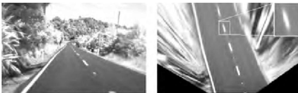
**Рис. 6.** Нормализация изображения. Пространственное разрешение падает по мере удаления от камеры. Иллюстрация заимствована из [24].
