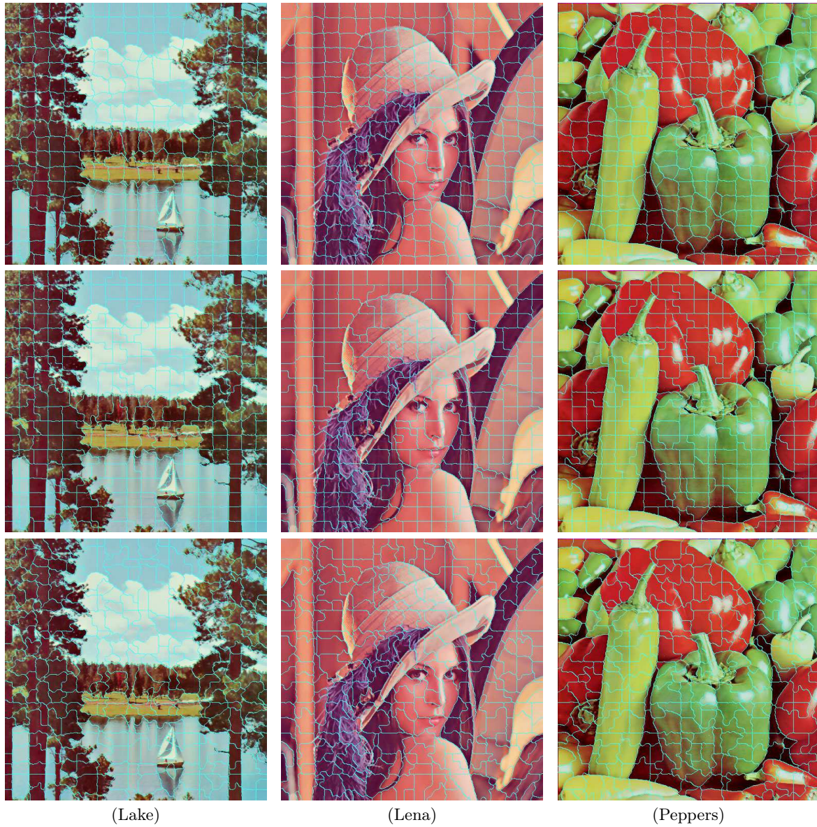
Рис. 3. Визуальный результат сегментации предложенного алгоритма для 300 сегментов. Верхняя строка представляет сегментацию, полученную после прямой реализации алгоритма, средняя — при пирамидальной реализации фильтра с шагом 4, и нижняя строка — для шага 2.
