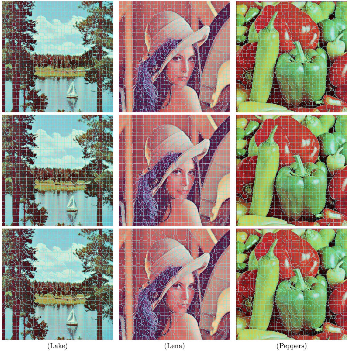
Рис. 5. Визуальный результат сегментации предложенного алгоритма для 300 сегментов. Верхняя строка представляет сегментацию, полученную после прямой реализации алгоритма, средняя — при пирамидальной реализации фильтра с шагом 4, и нижняя строка — для шага 2.
