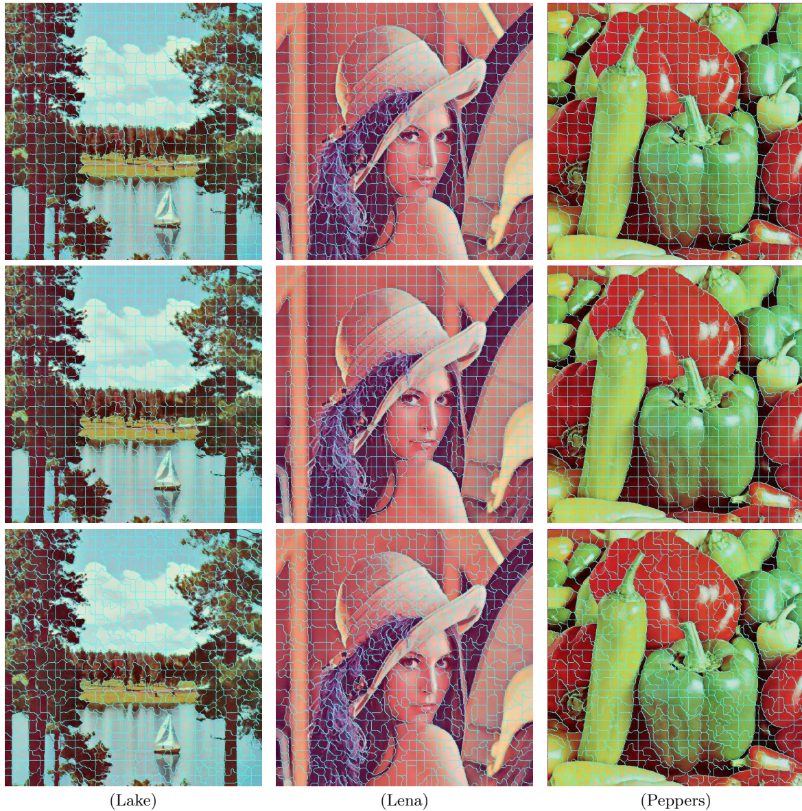
Рис. 4. Визуальный результат сегментации предложенного алгоритма для 600 сегментов. Верхняя строка представляет сегментацию, полученную после прямой реализации алгоритма, средняя — при пирамидальной реализации фильтра с шагом 4, и нижняя строка — для шага 2.
