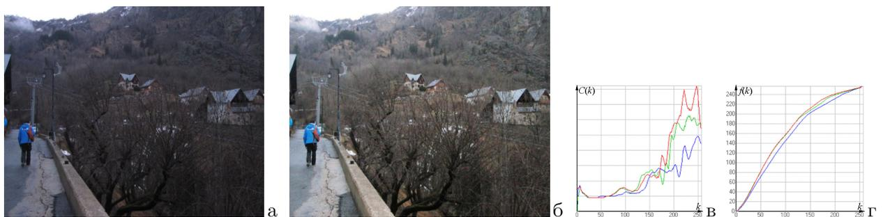
Рис. 8. а) исходное изображение; б) результат обработки; в) функции  $C(k)$ ; г) функции  $f(k)$ .
