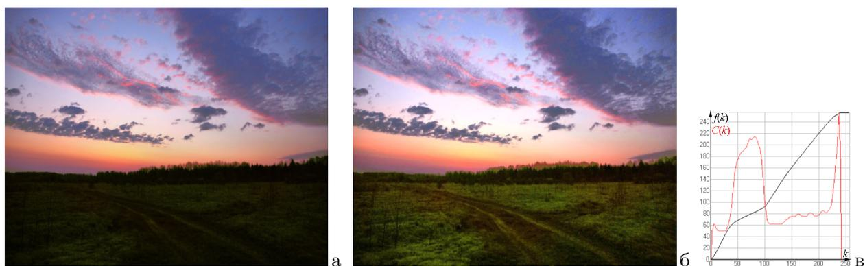
Рис. 13. а) исходное изображение; б) трансформация в формат *BHS* и преобразование компоненты яркости *B*; в) функции  $C(k)$  (красная) и  $f(k)$  (черная).
