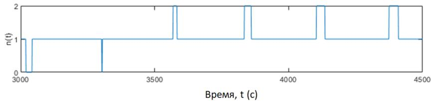
**Рис. 5.** Примерный вид зависимости количества доступных КА от времени  $n(t)$  на интервале длиной 1500 секунд для АТ в точке  $20^\circ$  с. ш.  $57^\circ$  в. д.
