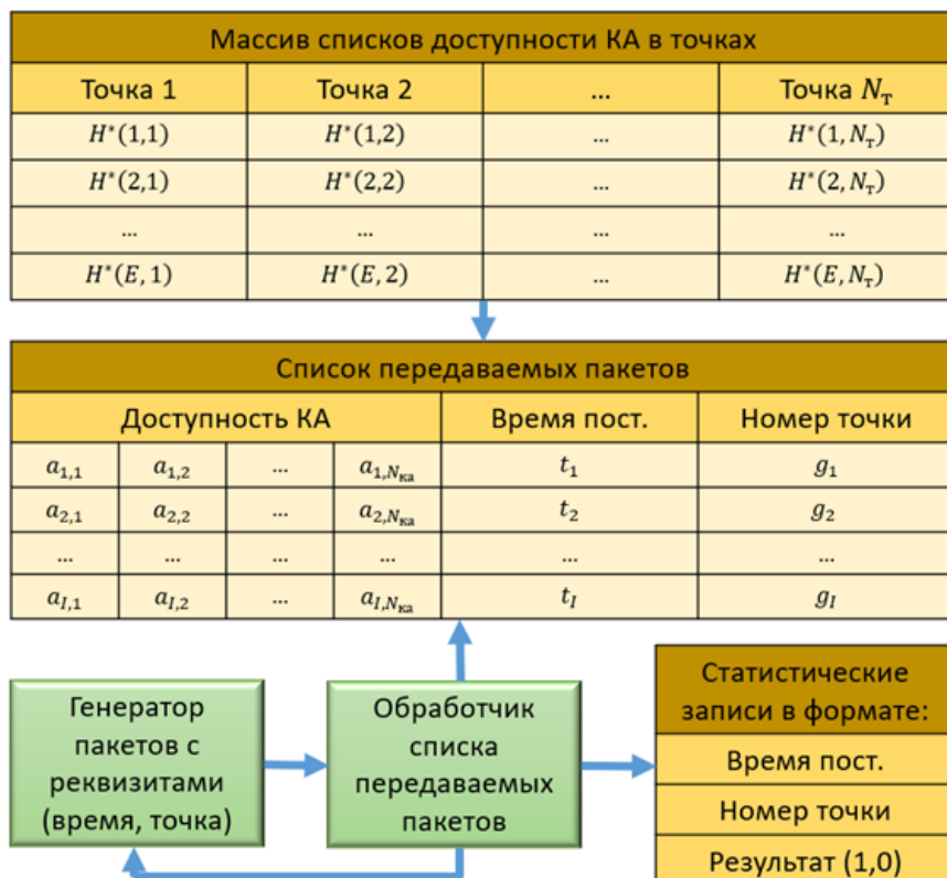
Рис. 3. Основные информационные и программные блоки, используемые в сценарии имитации процесса функционирования сети и набора статистики, и их взаимодействие между собой
