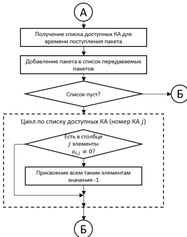
Рис. 5. Алгоритм работы сценария имитации процесса функционирования сети и набора статистики (окончание)
