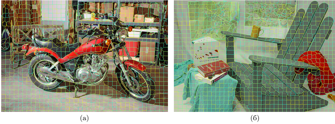
Рис. 3. (a) — Результат суперпиксель-сегментации для стереоизображения Adirondack из Middlebury dataset; (б) — Результат суперпиксель-сегментации для стереоизображения Motorcycle из Middlebury dataset.
